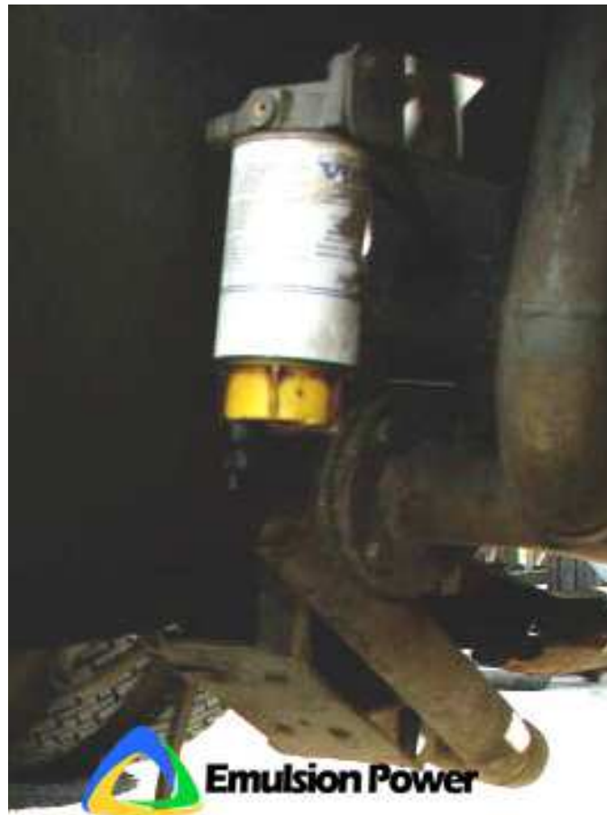
Figura 6 Filtro installato sull'automezzo Volvo
