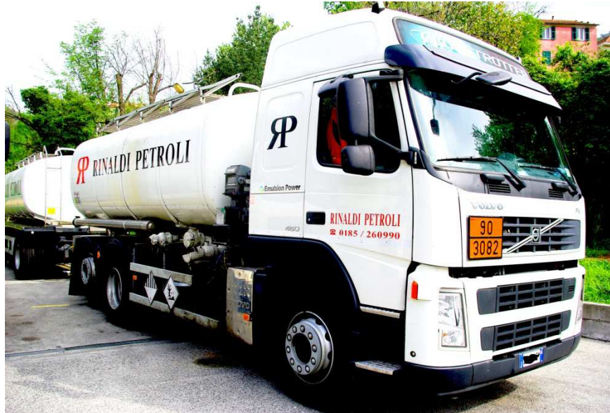
Figura 4 Volvo FM 460 EURO 5 alimentato a STABLE EMULSION
