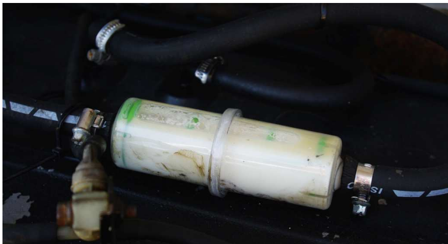
Figura 5 Pre-filtro decantatore installato sull'automezzo Mitsubishi
