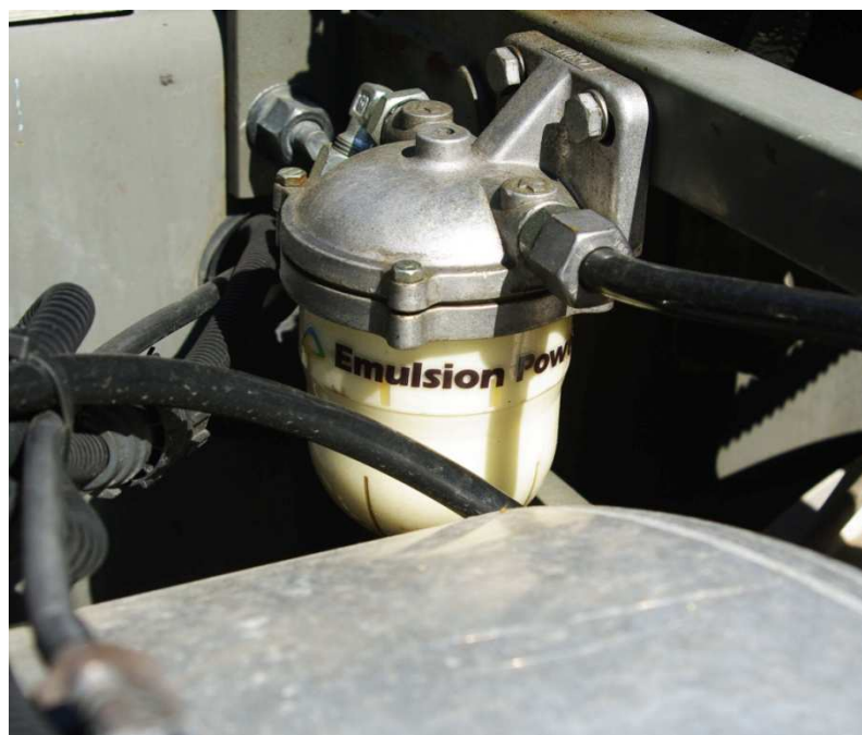
Figura 7 Pre-filtro decantatore installato sull'automezzo Volvo
